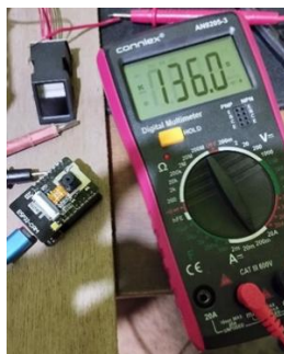
GAMBAR 3 PENGUKURAN ARUS SINYAL SENSOR KAMERA ESP32CAM
