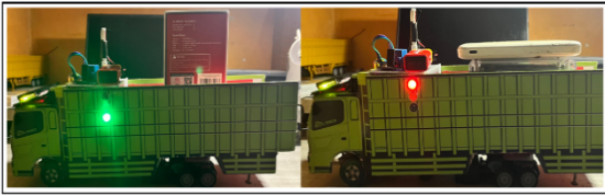
GAMBAR 7 PENGUJIAN RESPON LED PADA BEBAN AMAN DAN BERLEBIH
