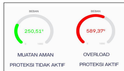
GAMBAR 6. PENGUJIAN TAMPILAN INFORMASI BERAT PADA BLYNK
