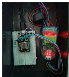
GAMBAR 4 INDIKATOR RANGKAIAN SENSOR MENGIRIM DATA PEMBACAAN
