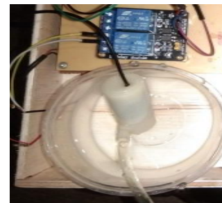
GAMBAR 3. IMPLEMENTASI POMPA 5V DC PADA RELAY
