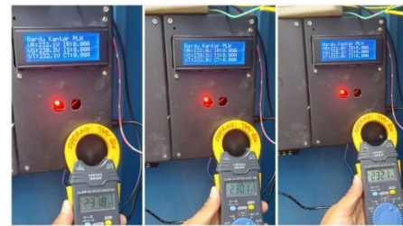
GAMBAR 8. PERBANDINGAN PEMBACAAN TEGANGAN ALAT UKUR KONVENSIIONAL DAN SENSOR PZEM-004T
