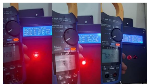
GAMBAR 9. PERBANDINGAN PEMBACAAN ARUS ALAT UKUR KONVENSIIONAL DAN SENSOR PZEM-004T
